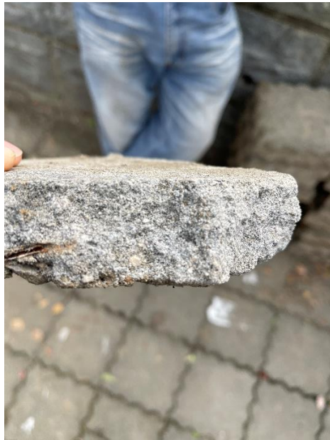
【乾拌水泥砂硬化後仍保有微弱孔隙，有利透水透氣】
